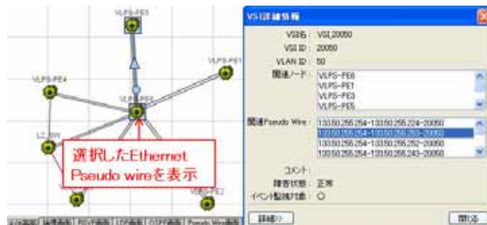
図 4 . VPLS を構成している Ethernet Pseudowire の経路検索機能利用画面
